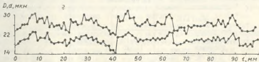
Рис. 78. Характерные колебания поперечных размеров медного микропровода на длине (м):
