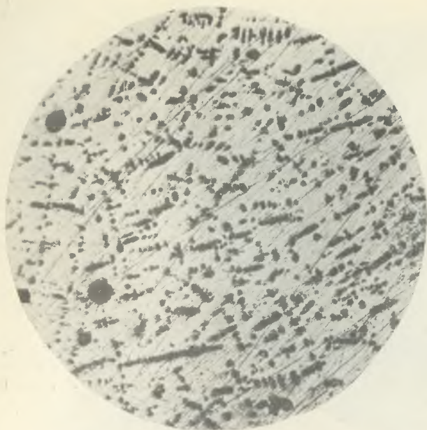
Рис. 7. Микрошлиф микро- ванны на 15-й минуте (не трав- ленный). Темные включения ти- па дендритов — силикаты, от- дельные крупные включения— силикаты, всплывшие в верх- нюю часть микрованны ( \times 150 )
